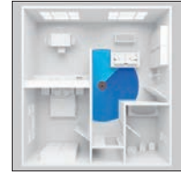
Cartographie automatique de l'espace, murs virtuels et navigation laser (LiDAR)
