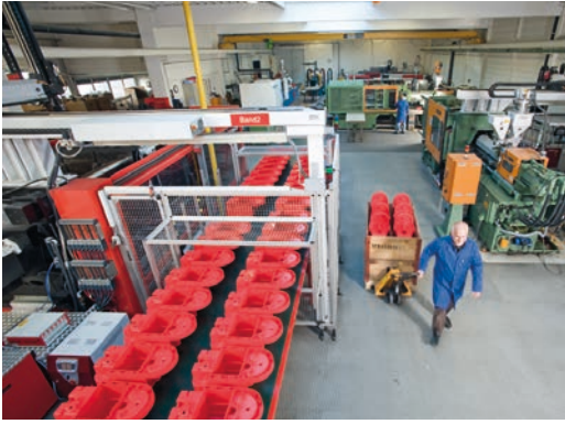
Moulage par injection de plastique
