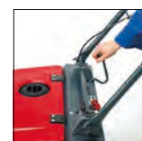
Hebel Seitenbesen absenken / anheben
