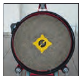
Maschine mit inte- griertem Treibteller
