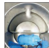
Integrierte Pumpe und Grobsieb
